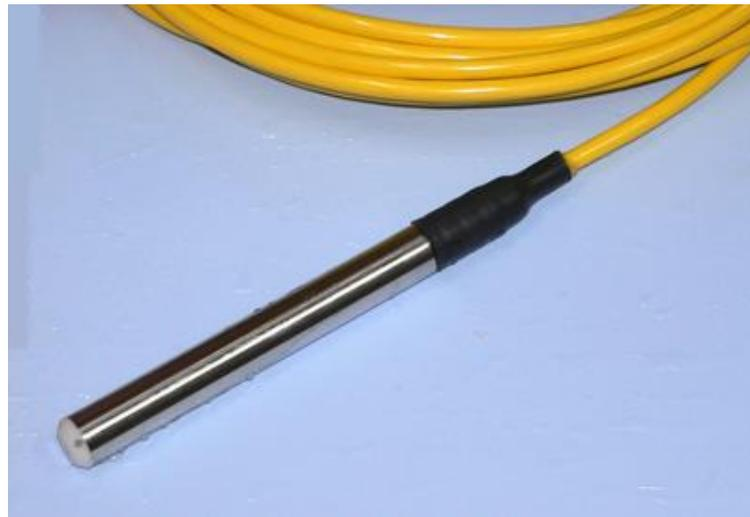
M86シリーズ水圧式水位センサは、投げ込み型の水位センサで、水深変化による水圧変化を電気信号に変換して水位を計測します。大気圧の変化から影響を受けないよう大気圧補正チューブが入っています。4～20mAの出力が得られますので、各種アナログ記録計に接続することができます。感部には機械的可動部がありませんので、長期間安定して使用することができます。感部が小型なので、細井戸の観測にも、使用できます。
